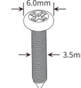
使用服务器上的2个壁挂孔，标记2个挂墙螺钉的正确位置 (挂墙螺钉的水平距离应为81.3mm)
